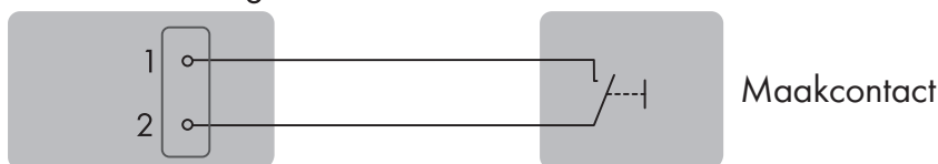
Afbeelding 8: Aansluitvoorbeeld van een schakelaar voor de snel-stop
