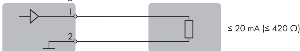
Afbeelding 10: Aansluiting van een analoge ontvanger
