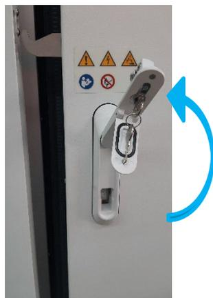
FIGURE 16: TURNING LEVER BY 180°
