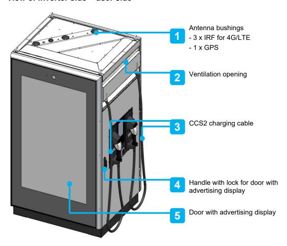
FIGURE 3: VIEW OF INVERTER SIDE + USER SIDE
