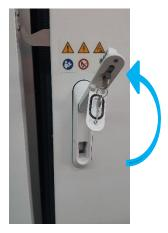
FIGURE 16: TURNING LEVER BY 180°
